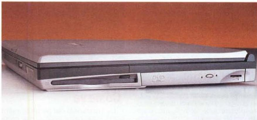
Lato anteriore: sul bordo superiore è posto il pulsante a slitta per l'apertura del display e, al centro, la leva di accensione; vicino a quest'ultima troviamo un gruppo di cinque LED indicanti lo stato della macchina.
